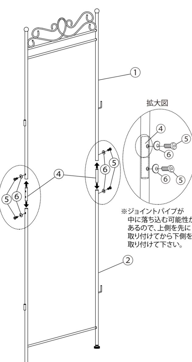
※ジョイントパイプが中に落ち込む可能性があるため、上側を先に取り付けしてから下側を取り付けて下さい。
