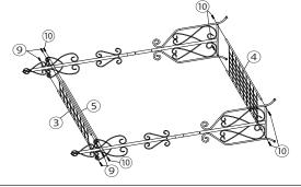
●⑤ハンガーパイプを①本体の図の3箇所 3 お好きな高さに⑩ボルト(長)で⑪六角レンチを 使用して仮締めして下さい。
