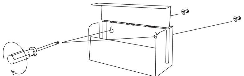
木ネジを穴に通し、引っ掛けた状態にしたらプラスドライバーで締め付けてください。
