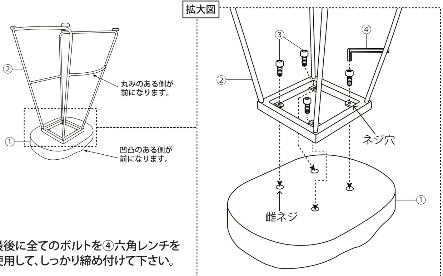
最後に全てのボルトを④六角レンチを使用して、しっかり締め付けて下さい。
