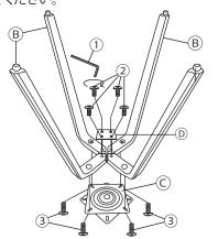
©回転盤の上部分の穴に先程の脚を③長ボルトで仮締めし、バランスを取りながら①六角レンチでしっかり締め付けてください。
