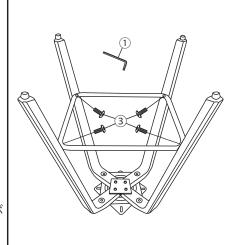
3 工程 1,2で組み立てた脚を⑥座板の裏の穴に②短ボルトを①六角レンチでしっかり締め付けて下さい。
