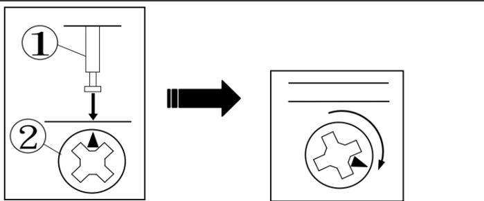
②カムロックを差し込む時は、印が右にくるように回して、プラスドライバーでこの▲印を①固定用ボルトに向けてください。
